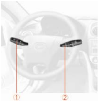
1.灯光和转向信号指示灯开关 2.风挡玻璃刮水器和洗涤器开关
