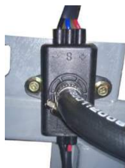
真空泵控制器
