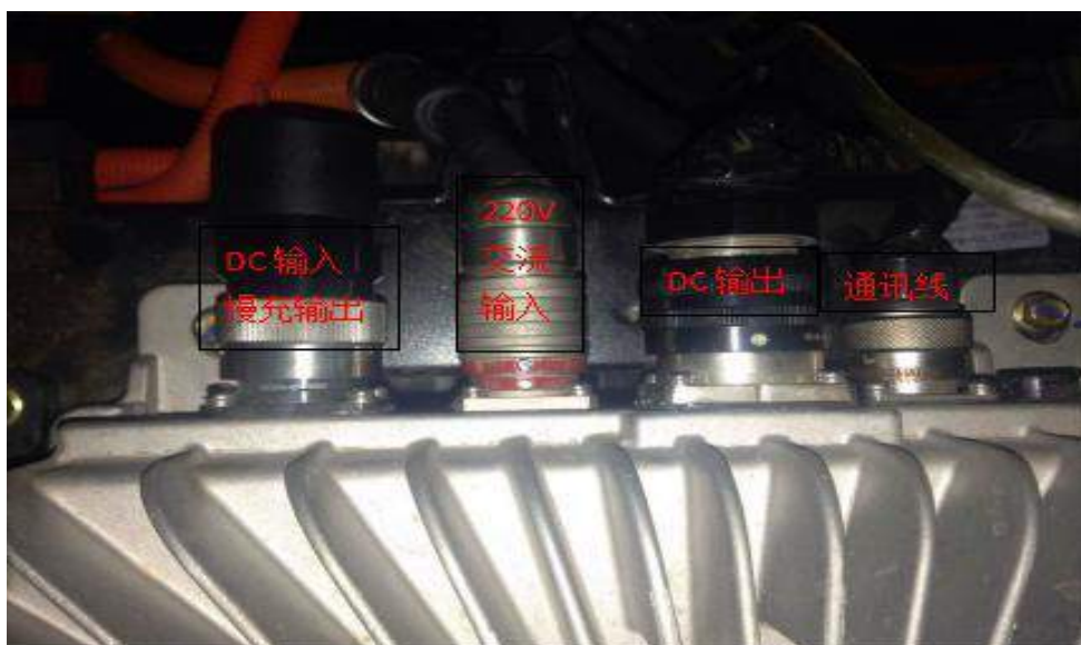
图 4.12 一体机线束接口示意图
