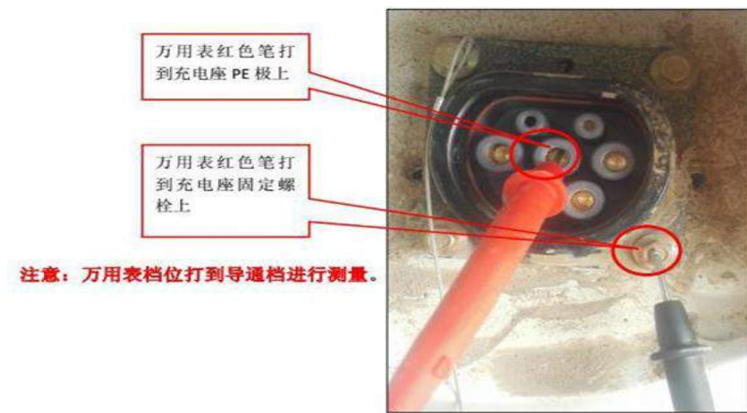
图 4.11 测量接地导通示意图
