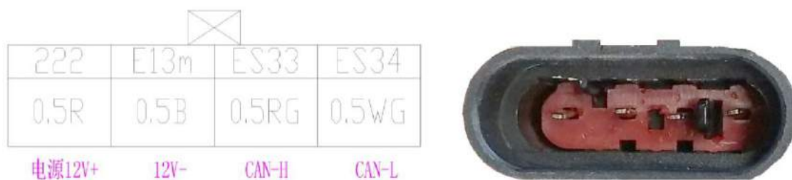
图 3.3 充电机插接件（左侧位车身线束图，右侧为充电机插接件）
