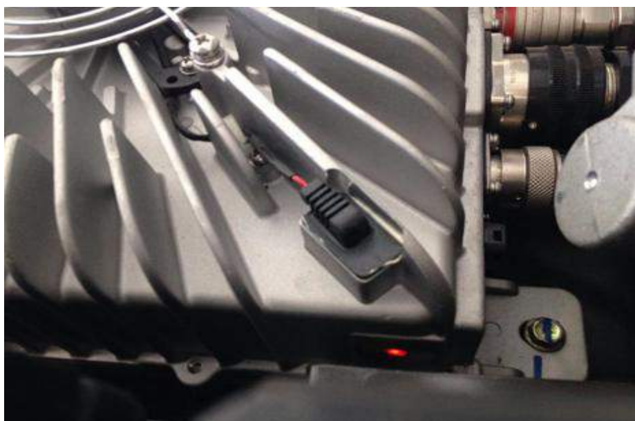
图 4.14 充电机充电指示灯示意
