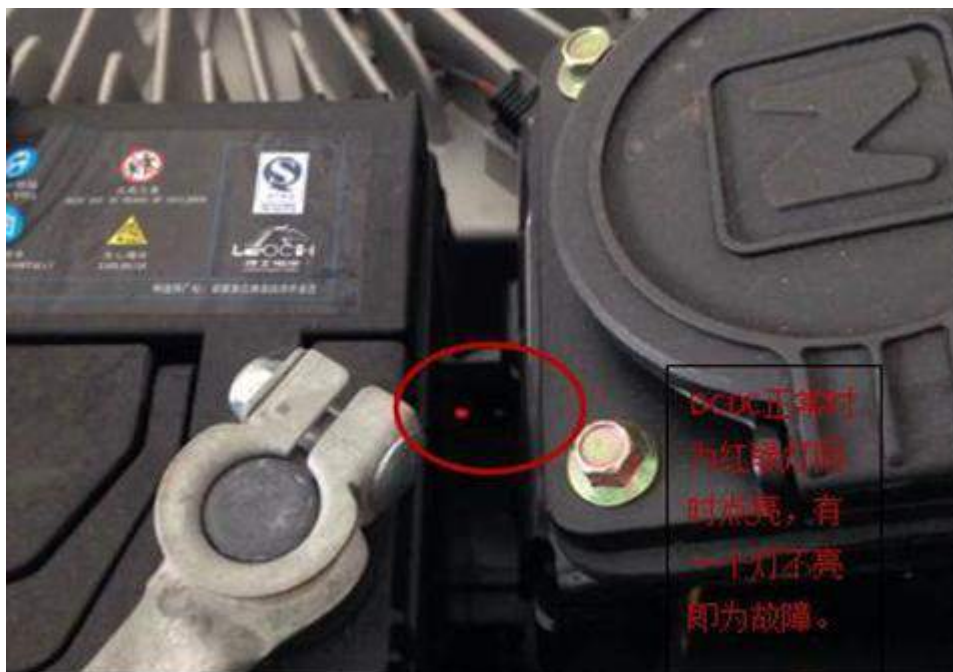
图 4.8 充电一体机 DCDC 指示灯示意图
